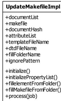
Figura 4.8 Diagrama de clases del componente build-makefile
