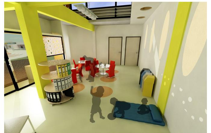
IMAGEN 117— Imagen que muestra el área interna de la guardería, en su espacio maternal. Se observa la incidencia de la luz natural sobre las paredes, tanto debido al tamizaje del material en fachada, como de los tragaluces de color en la cubierta. Fuente: propia
