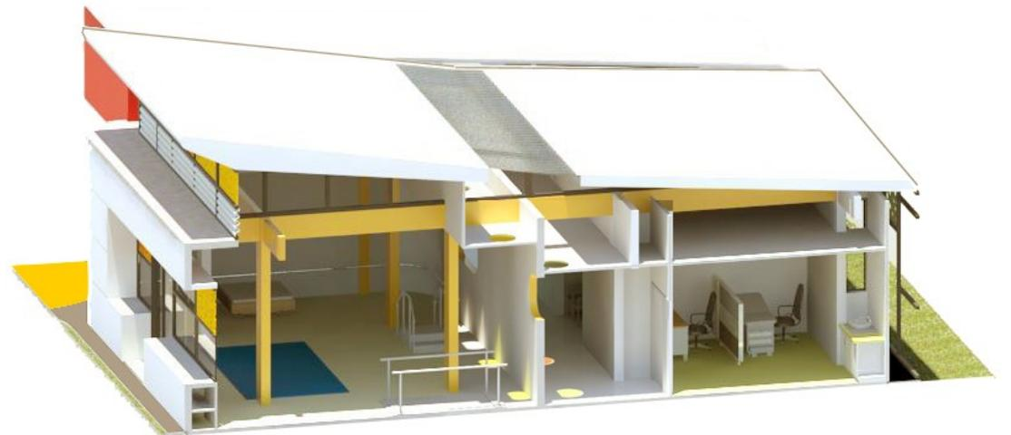
IMAGEN 99— Sección fugada del área de mecanoterapia y consultorio tipo, según la indicación en el plano 11. Fuente: propia
