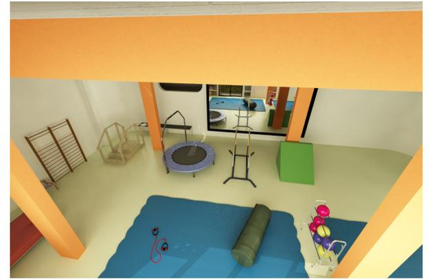
IMAGEN 105— Vista desde la viga estructural, expuesta, dentro del gimnasio de mecanoterapia. Las vigas expuestas permiten colocar los múltiples instrumentos que requieren sujeción como columpios, argollas, etc., como se muestra en la imagen 106. Fuente: propia
