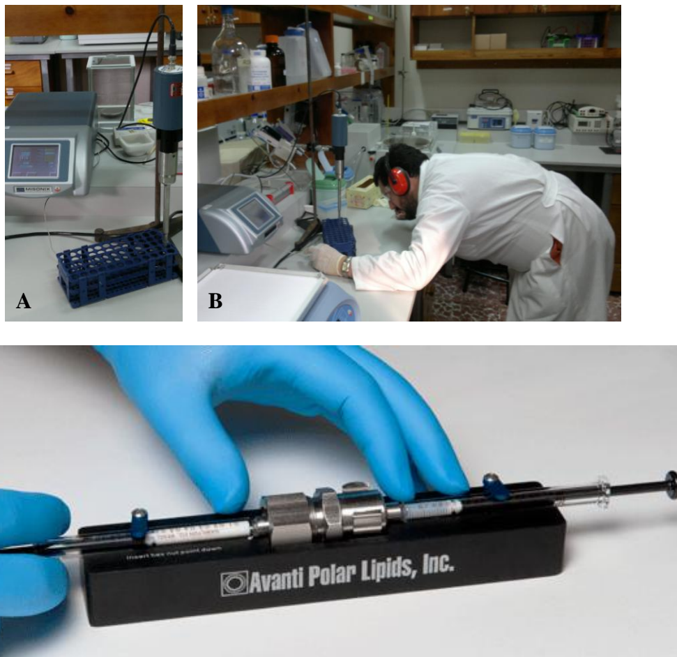
Figura 1A. Preparación de los liposomas a partir de lecitina natural (A: Sonicador de punta; B: Uso del Sonicador; C: Miniextruder).
