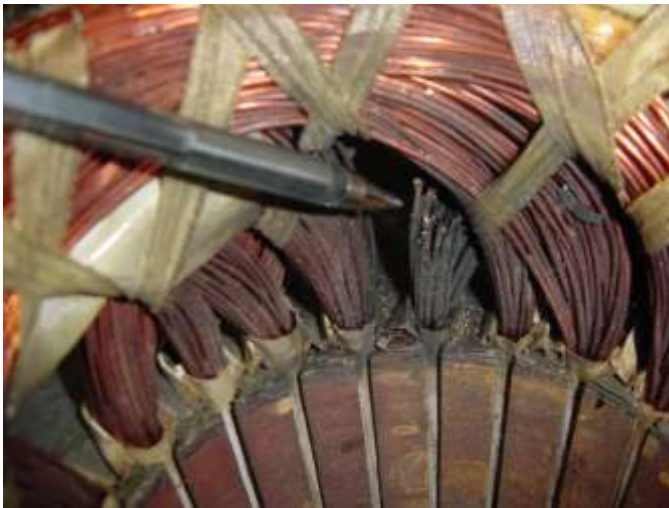
Figura N°6. Fotografía Falla Corto Estator
