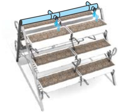
Se utilizan dos tipos de tubo: de 3 pulgadas, para el flujo de agua de los tanques de tilapia a las camas, y de 1 pulgada para el desague de las camas de crecimiento y el flujo hacia el tanque de reserva.
