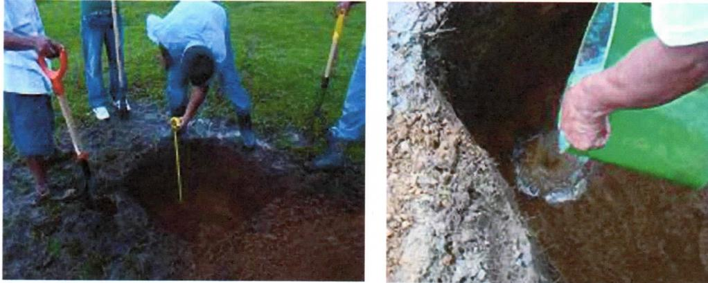
**Fig. 4** Realización de las pruebas de infiltración por parte de los estudiantes
