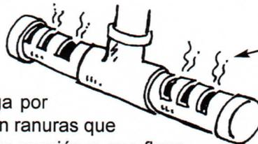
tubería con ranuras para distribuir a la entrada y recoger a la salida uniformemente las aguas
