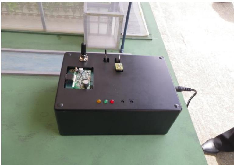
Figura 8. Sensor de clima múltiple autónomo con antena para captación de la información vía bluetooth
