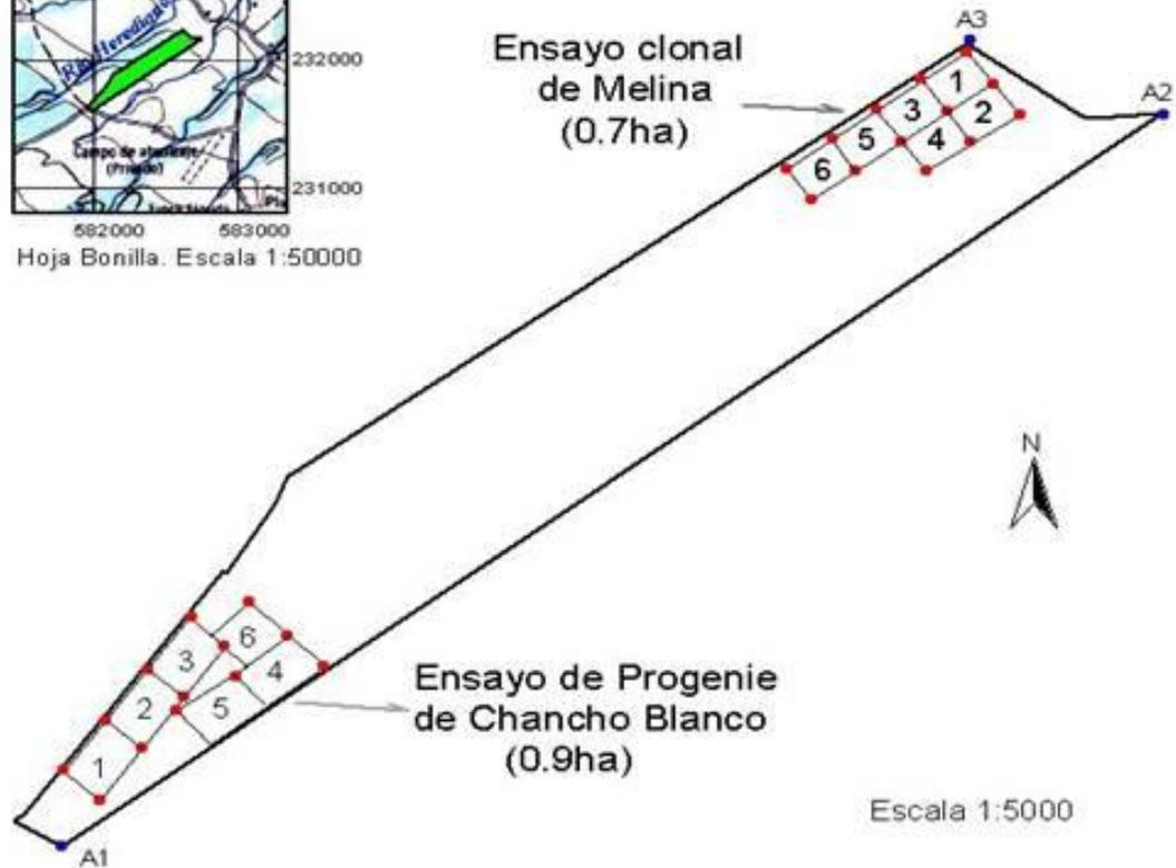
Levantamiento poligonal abierta, errores no se calculan por método usado.
