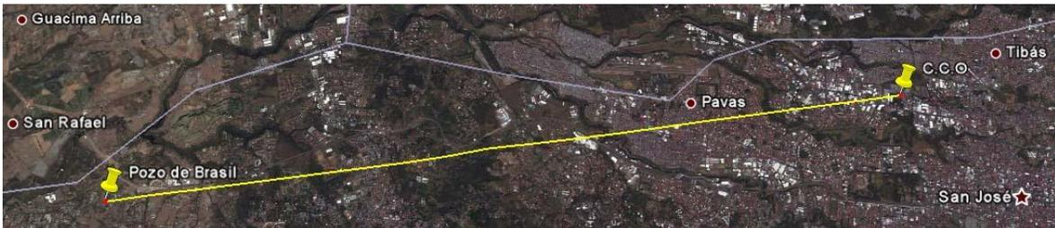
**Figura 5.1** Foto satelital del enlace entre el CCO y Pozo de Brasil
