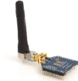
Figura 3. XBee
