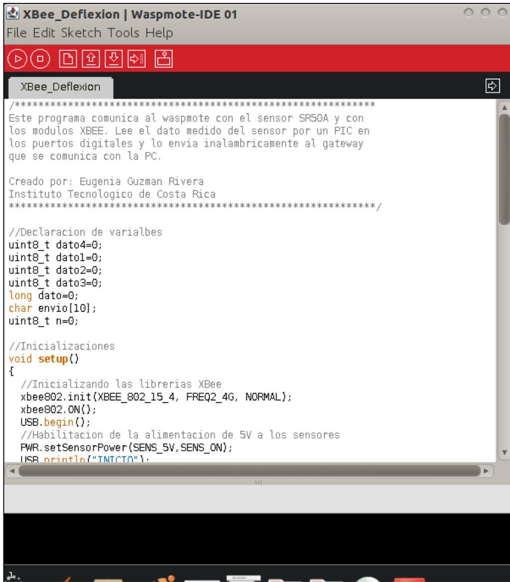
**Figura A.2.5.8** Programa para la lectura del sensor SR50A en el Waspote
