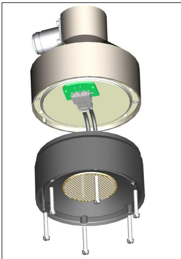
**Figura 42.** Remover los tornillos de la cubierta del transductor SR50A y desconectar los cables [6]
