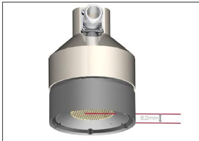
**Figura A.2.2.7.** Distancia de la parrilla frontal a la cubierta de plástico [6]
