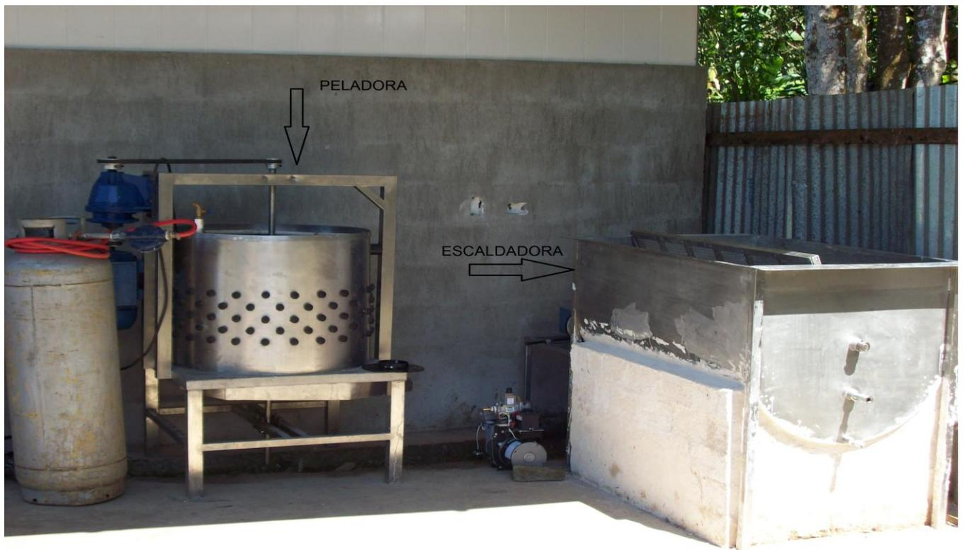
**Figura 6.1** Implementación final de las máquinas escaldadora y peladora
