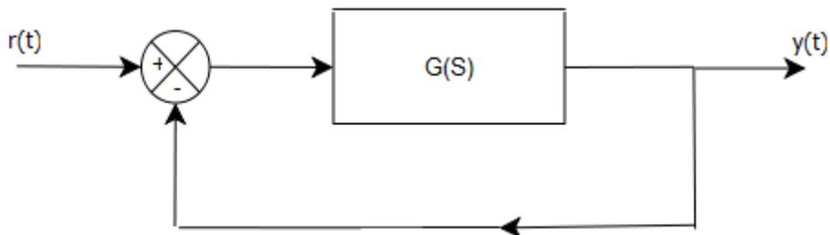
**Figura 5.15** Diagrama del modelo teórico con realimentación unitaria (control de nivel)
