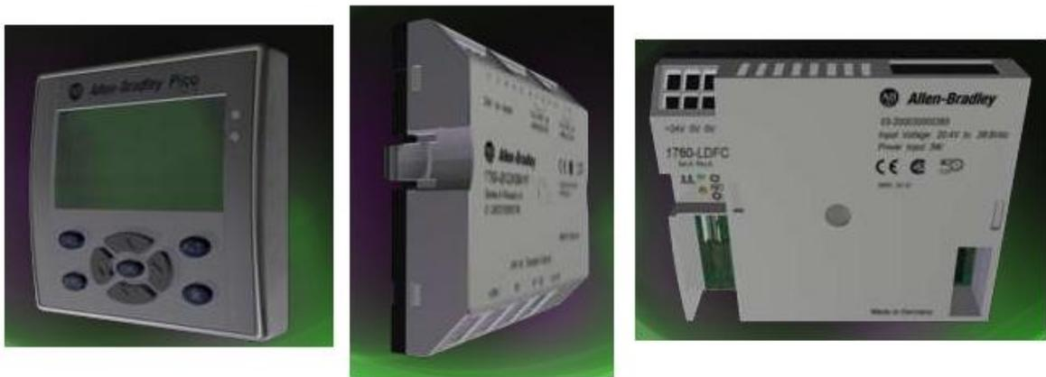
**Figura 5.26** PLC Pico-GFX 70 utilizado en el proyecto
