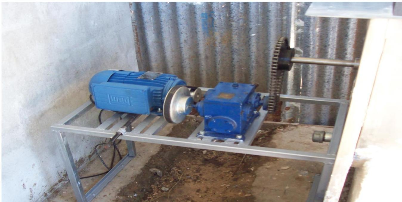
**Figura 6.5** Montaje para el funcionamiento del motor de la máquina escaldadora
