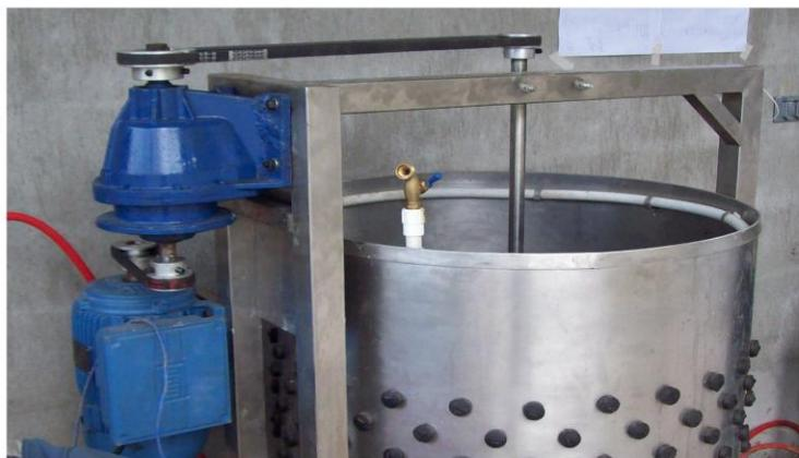
**Figura 6.6** Montaje para el funcionamiento del motor de la máquina peladora
