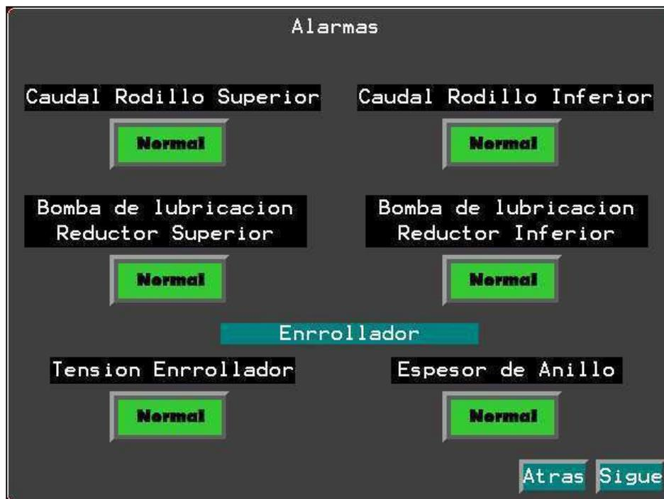
Figura 5.29. Pantalla de alarmas del Caster y el Enrollador.
