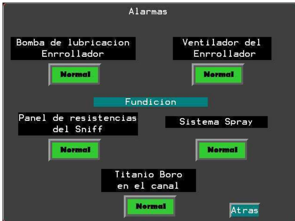
Figura 5.30. Pantalla de alarmas del Enrollador y Fundición.
