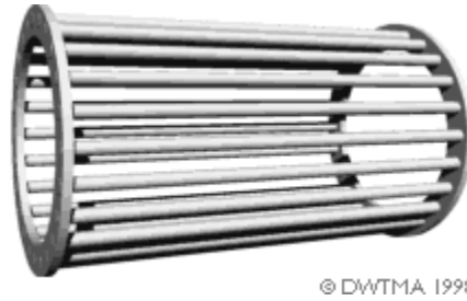
Figura 3.2. Barras conductoras del Rotor Jaula de Ardilla. 2
