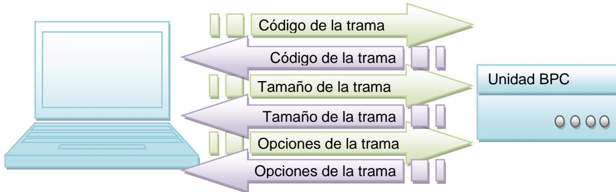
Figura 11: Transferencia de un comando al sistema BPC [7]
