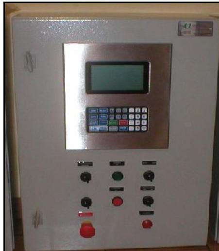
**Figura 5.8.** Tablero del controlador GSE 665.
