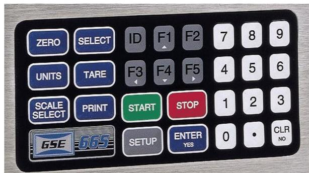
Figura 3.14. Teclado del controlador GSE 665<sup>11</sup>.
