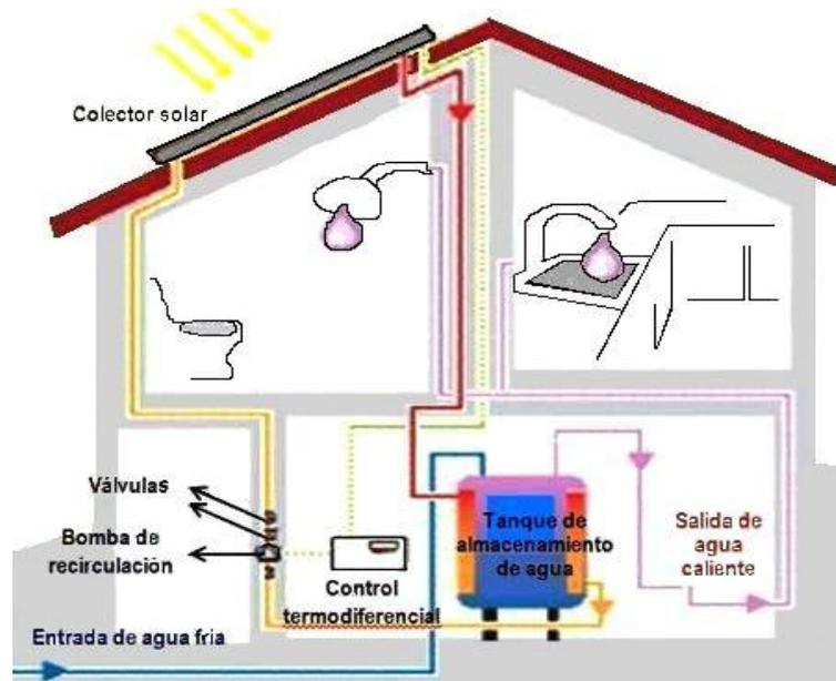
**Figura 3.3** Imagen de un sistema termosifónico forzado. [1]
