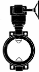
Figura 6 Ejemplo de válvula tipo mariposa [5]
