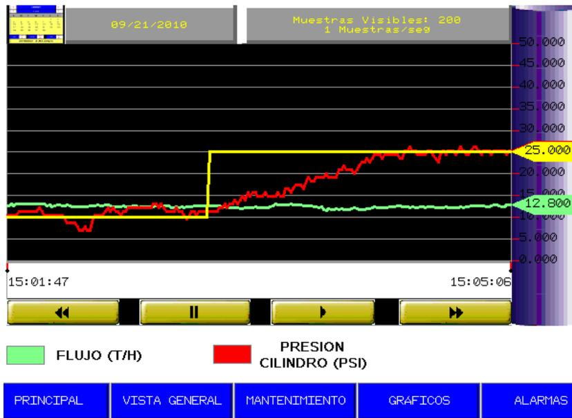
Figura 6.1.10 Respuesta real del sistema a lazo cerrado ante una entrada escalón de 25psi.
