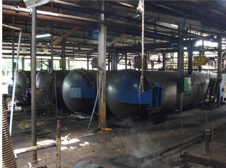
**Figura 3.1.1** Esterilizadores (Autoclaves)
