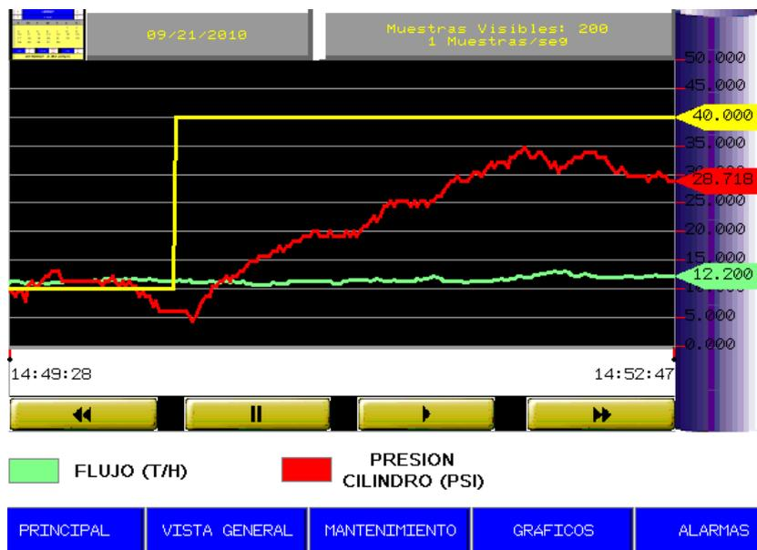
**Figura 6.1.9** Respuesta real del sistema a lazo cerrado ante una entrada escalón de 40psi.
