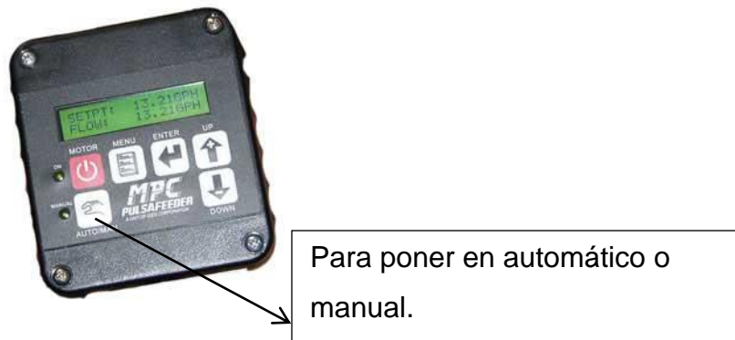
Figura A.25 Regulador de dosis de coagulante, Pulsa Feeder. Fuente Elaboración Propia.
