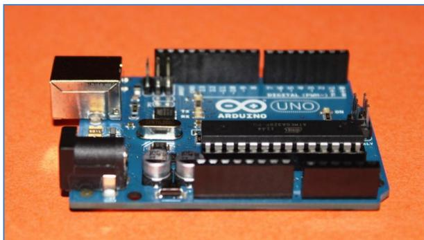
**Ilustración 5.13** Fotografía del microcontrolador ATmega328P y la placa de desarrollo Arduino UNO.
