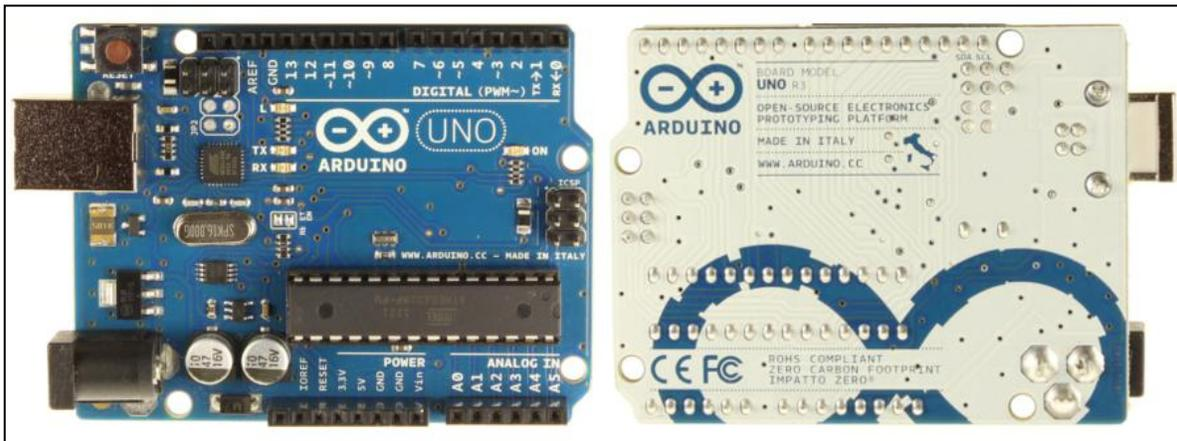
**Ilustración 5.12** Arduino UNO.<sup>10</sup>
