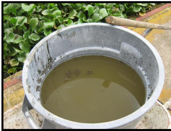
**Figura 4.2. Lodo inóculo, proveniente de la segunda laguna de oxidación del ITCR.**
