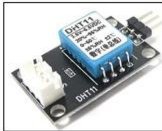
Figura 5.5 Sensor de temperatura DHT11 [1]
