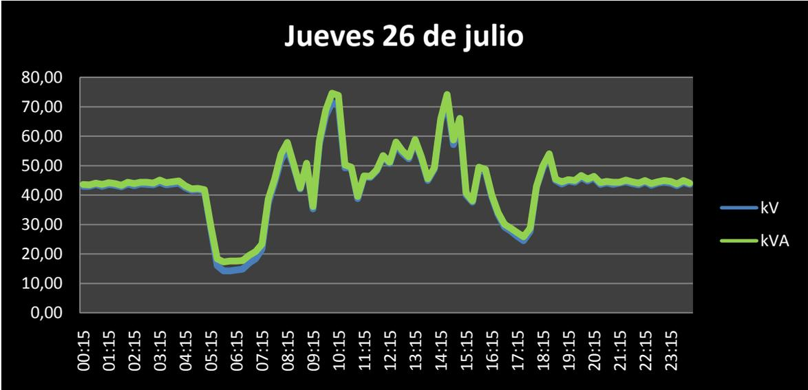
Figura 13. Curva de carga de la acometida 1
