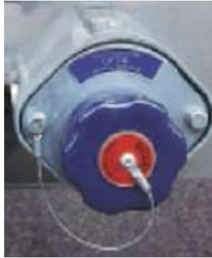
Figura 3.5 Socket para el sistema óptico (código de color azul).[6]
