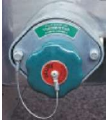
Figura 3.4 Socket para el sistema de termistor (código de color verde).[6]
