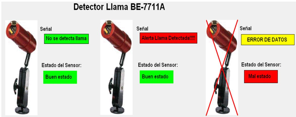
Figura 5.11 Diferentes estado para los detectores de llama en el sistema HMI
