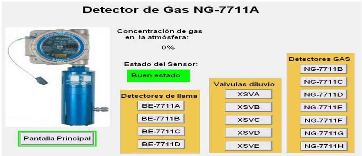
**Figura 5.12** Pantalla para los detectores de gas para el sistema HMI
