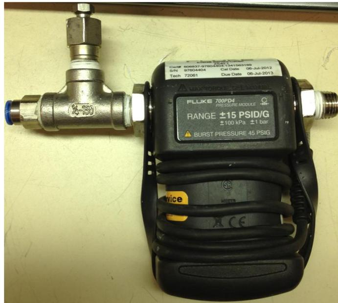
Figura 3.2.2 Sensor de Presión Modelo 700 PD4 (Fotografía)
