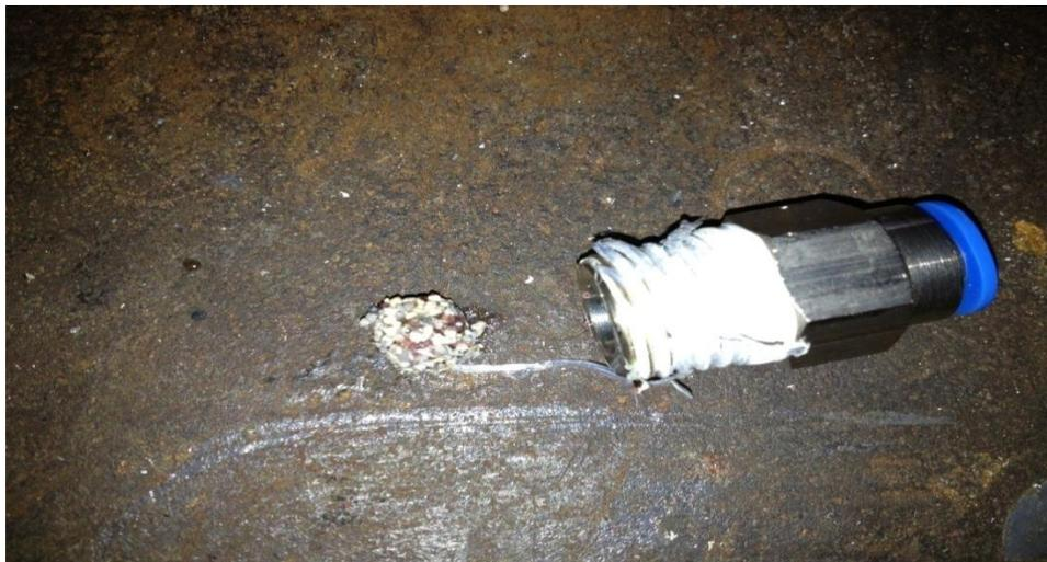
**Figura 6.1.1** Impacto de la Arena en la Tubería de los Transmisores del Make Up en el Sistema Rodi (Fotografía)
