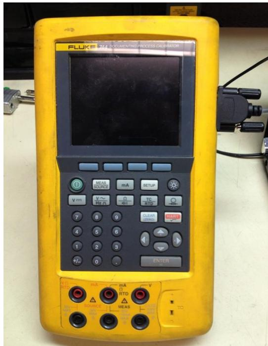
**Figura 3.2.1** Documentador y Calibrador de Procesos Fluke 744 (Fotografía)
