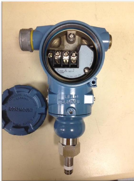
**Figura 3.3.2** Sensor de Presión y Transmisor Marca Rosemount Modelo 3051 (Fotografía)
