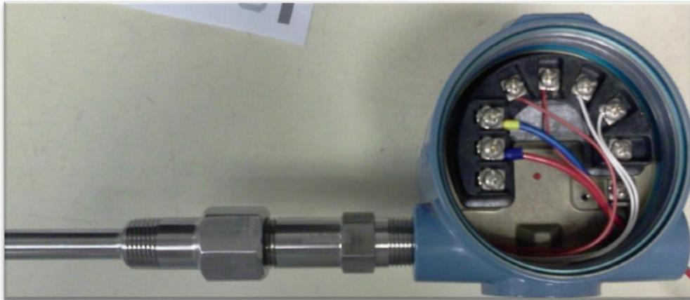
**Figura 3.3.4** Sensor de temperatura RTD utilizado en el sistema de detección de fallas con su respectivo transmisor (Fotografía)
