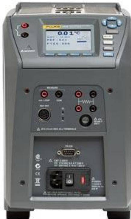
**Figura 3.2.3** Pozo Seco Fluke Modelo 9142 (Screenshot del Manual)
