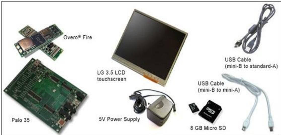
**Figura 6.** Paquete Overo inalámbrico que incluye el sistema embebido y el módulo de expansión. [5]
