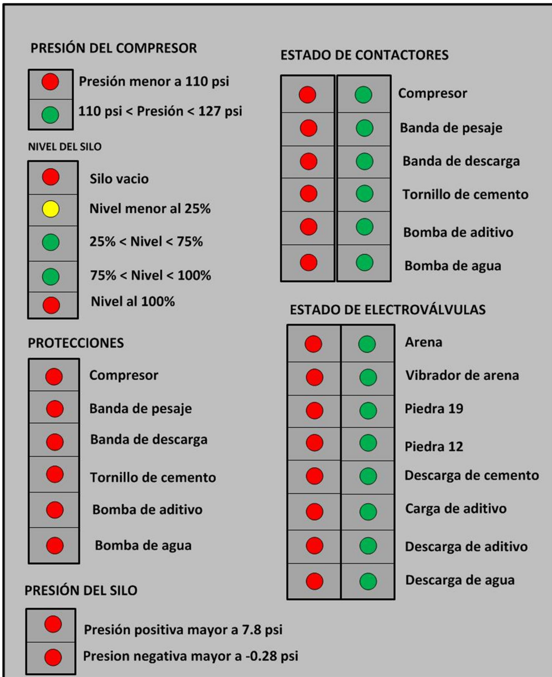
Figura 5.5. Panel de alarmas.
