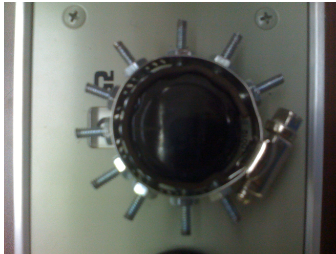
Figura 20. Y Figura 21. Estructuras auxiliares para las cajas de décadas y conmutadores.
