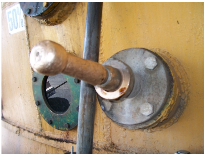
Figura 6.2 Sonda del tacho para pruebas de concentración.
