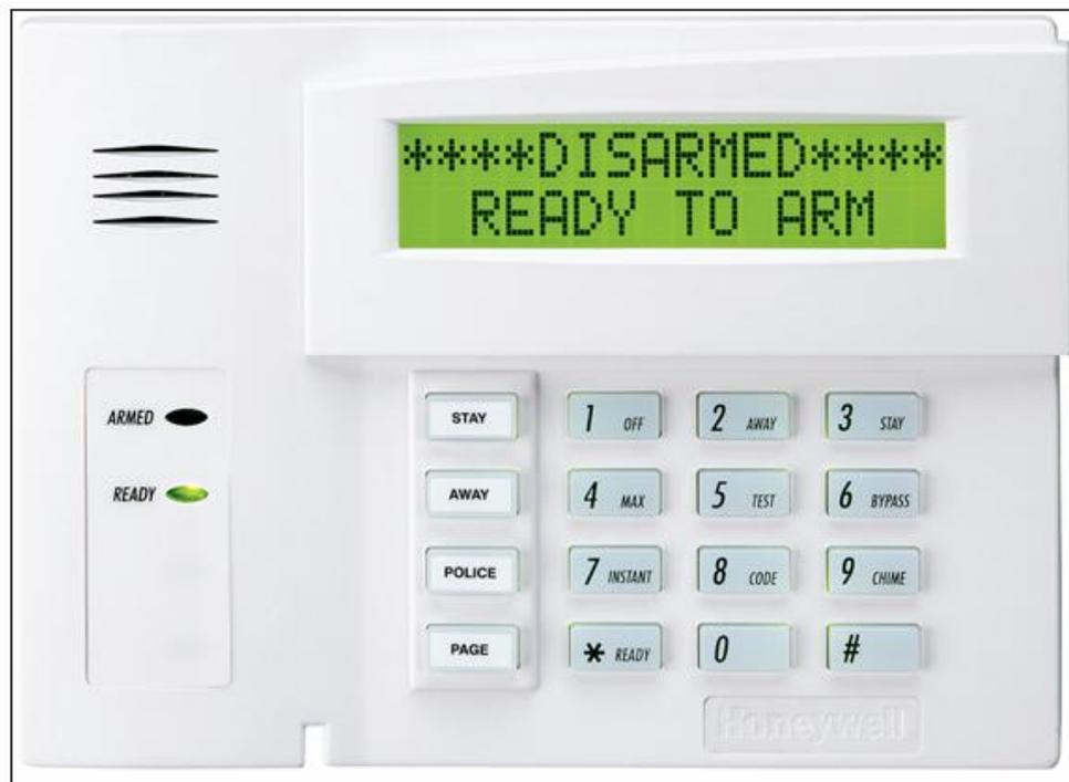
**Figura 3.1.1.2.** Teclado 6160 para configurar el panel Vista 128-FBP.
