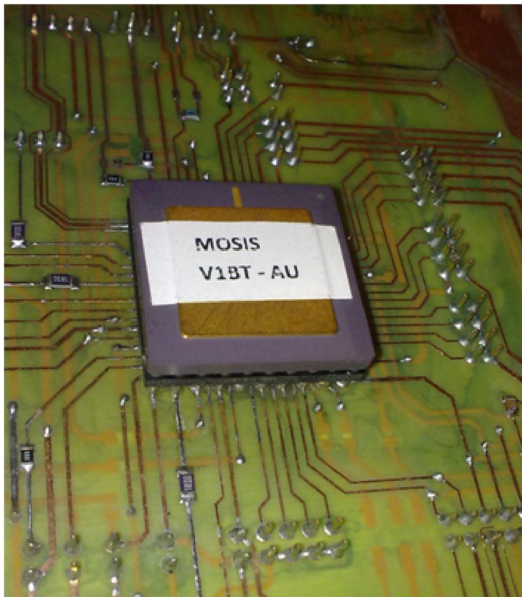
**Figura D.3:** Circuito integrado bajo prueba (ASIC).
