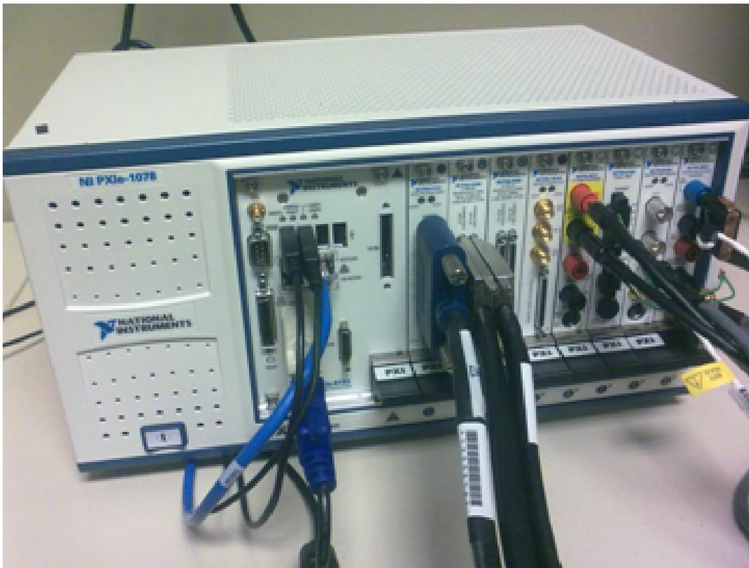
**Figura 4.1:** Plataforma PXI de la compañía NI de 9 ranuras con controlador integrado.
