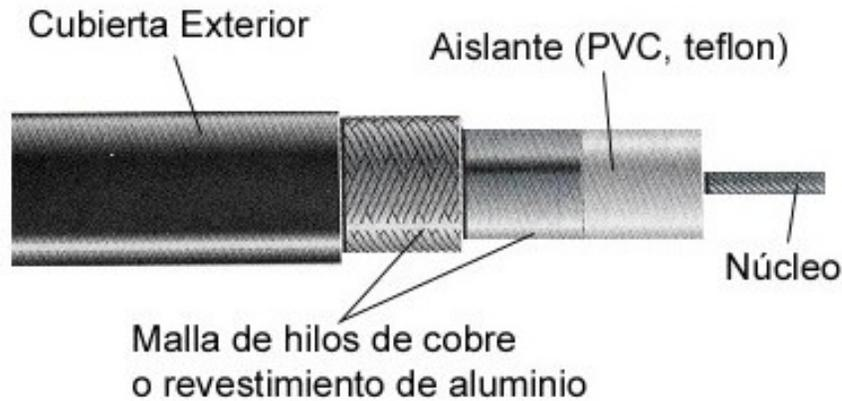
**Figura 3.2:** Estructura de un cable coaxial
