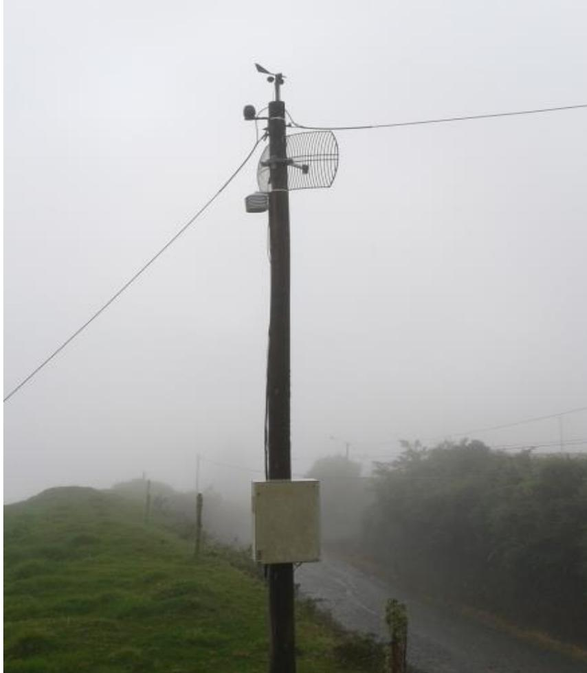
**Figura 5.41** Prototipo de la estación meteorológica instalada.
