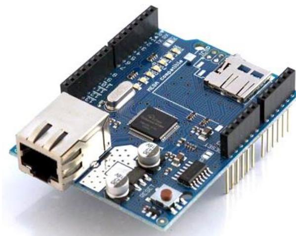
**Figura 4.9** Tarjeta Arduino Ethernet con socket microSD.
