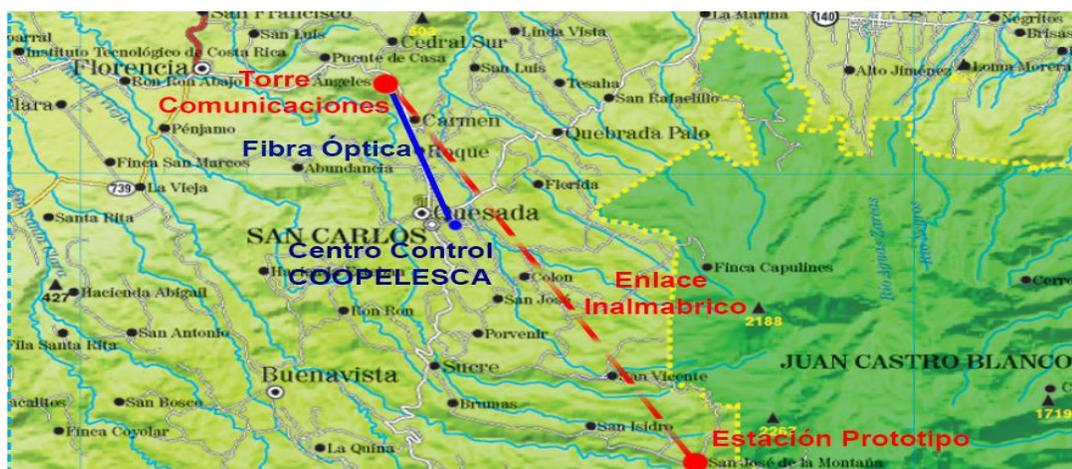
Figura 5.35 Enlace de comunicación de la estación prototipo con el Centro de Control.
