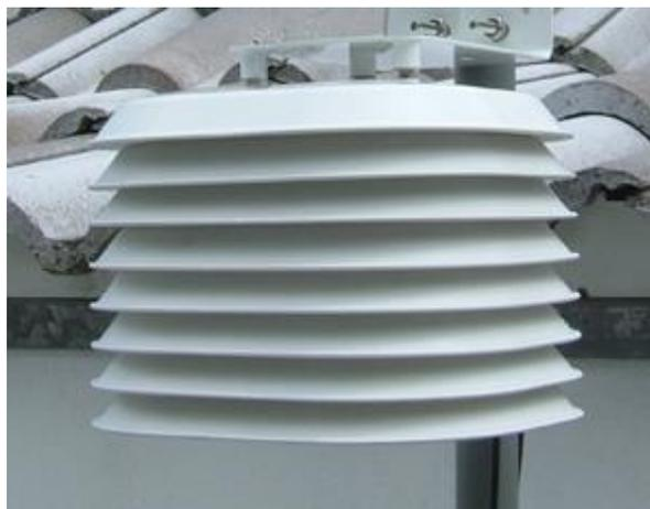
**Figura 4.3** Escudo solar para el sensor RHT03.
