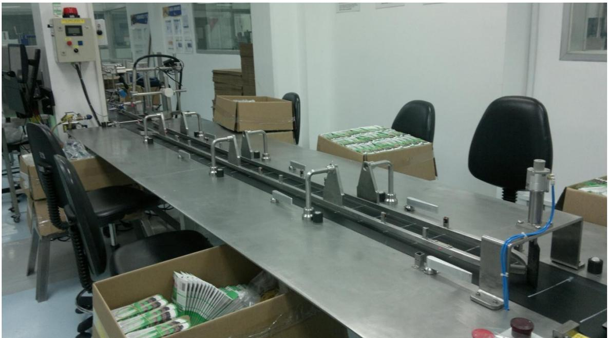
**Figura 5.14:** Implementación de las guías. Modelo real.
