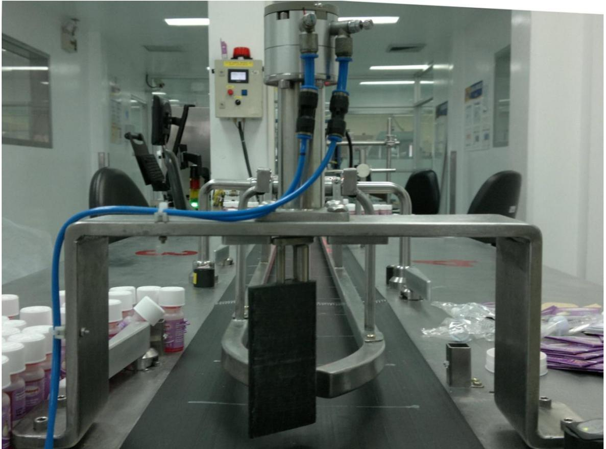
**Figura 5.18:** Implementación movimiento primer paleta desviadora.
