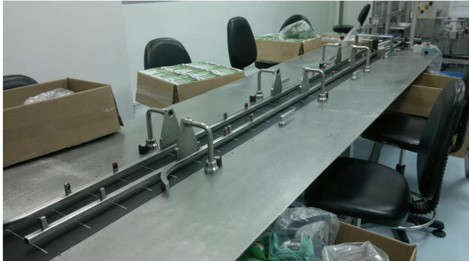
**Figura 5.15:** Implementación de las guías. Modelo real, vista desde atrás.
