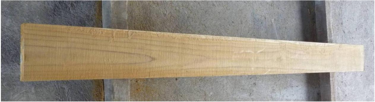
**Figura 15.** Ejemplo de una pieza totalmente duramen (D) en una tabla de madera verde aserrada sin cepillo de *T. grandis*. Guanacaste, 2012. Costa Rica.
