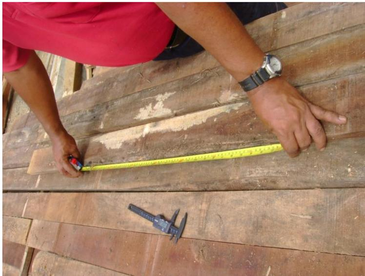
**Figura 7.** Medición de defectos en una pieza de madera verde sin cepillo de *T. grandis*. Costa Rica. 2012
