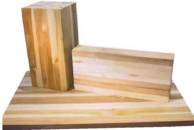
**Figura 2.** Columna, viga y panel construidos a partir de madera de plantación de *T. grandis*
