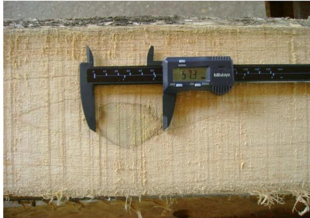
**Figura 10.** Medición de los nudos en tablas de madera de *T. grandis L.*
