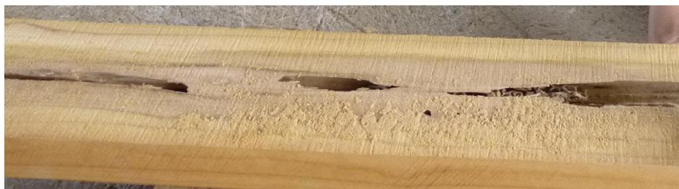
**Figura 21.** Daño por médula en una tabla de madera verde aserrada sin cepillo de *T. grandis*. Guanacaste, 2012. Costa Rica.
