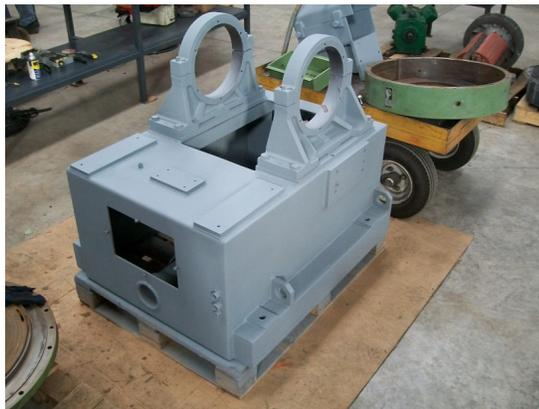
**Figura A.1:** Base del sistema y circunferencia de montaje de roles de estator
