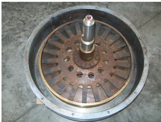
**Figura A.5:** Vista lateral del estator sin bobina
