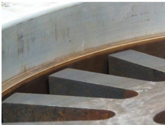
**Figura A.6:** Representación de la separación entre rotor, tapas de enfriamiento y aro de cobre
