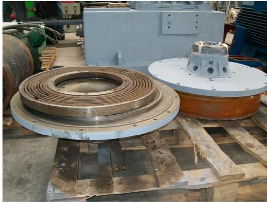
**Figura A.2:** Tapas del estator, bobina del sistema y tapas del sistema de refrigeramiento
