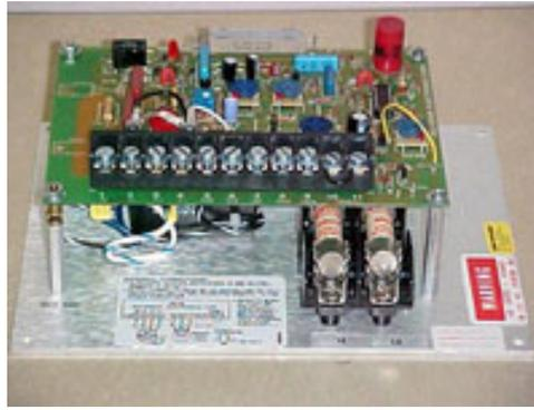
**Figura 2.19:** Tarjeta de control de tensión para bobina de freno electrodinámico
