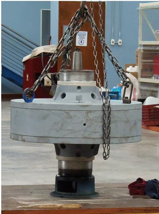
**Figura A.9:** Estator listo para ajuste de rotor y montaje de roles en base
