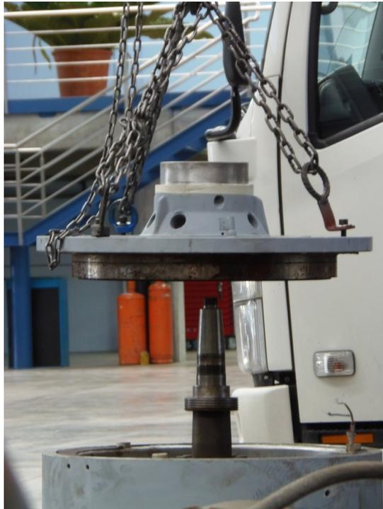
**Figura A.8:** Montaje de la segunda sección del estator
