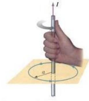
**Figura 2.13:** Determinación de dirección de líneas de campo magnético
