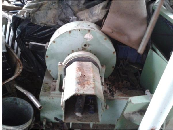
**Figura 3.1:** Estado de abandono de freno electrodinámico parte frontal
