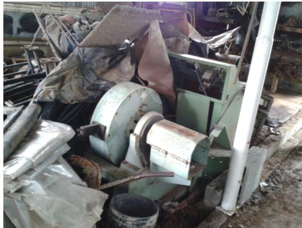
**Figura 3.2:** Estado de abandono de freno electrodinámico parte lateral
