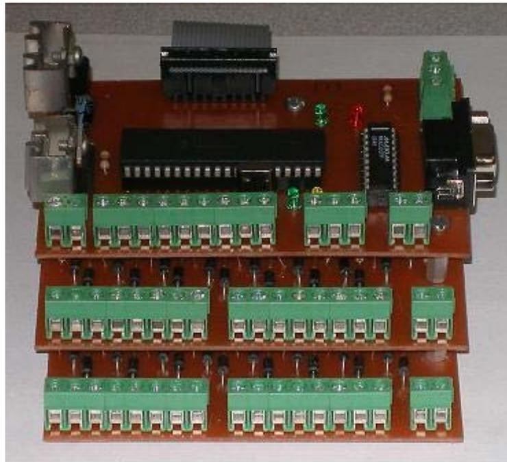
**Figura A.2.4.** Imagen de la Interfaz Modbus implementada en circuito impreso.
