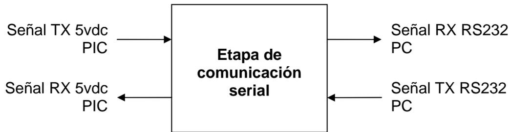
**Figura 5.6.** Diagrama de bloques de tercer nivel de la etapa de Comunicación serial
