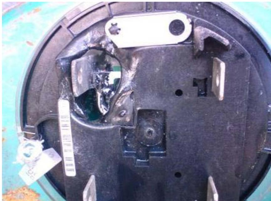
**Figura 5.7.** Medidor dañado debido a la exposición de altas temperaturas generadas por la potencia disipada al utilizar incorrectamente una base CL100 en medidores CL200.
