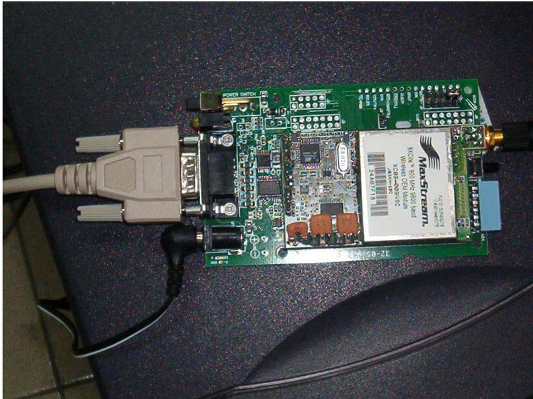
**Figura 6.2** Módulo de comunicación utilizado para la estación central de trabajo
