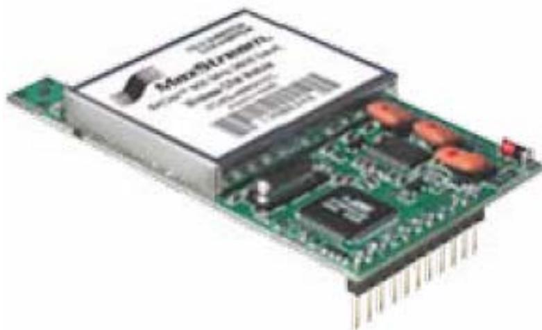
**Figura 1.2.3.3** Tarjeta de comunicación 9XCite OEM RF
