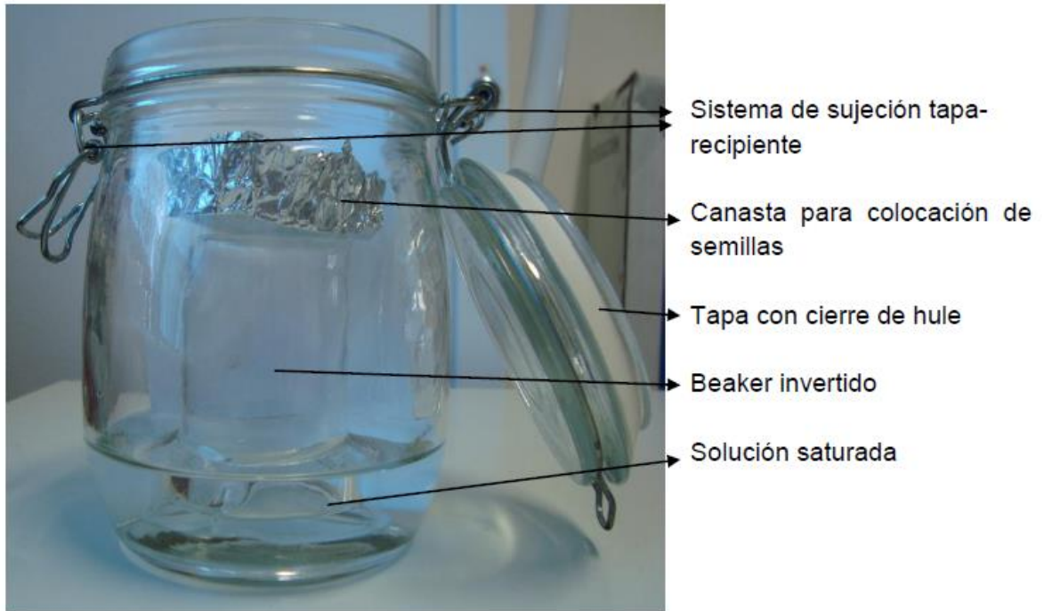
Figura 2. Sistema de deshidratación con sujeción de tapa y cierre, utilizado para deshidratar semillas de Epidendrum sp.
