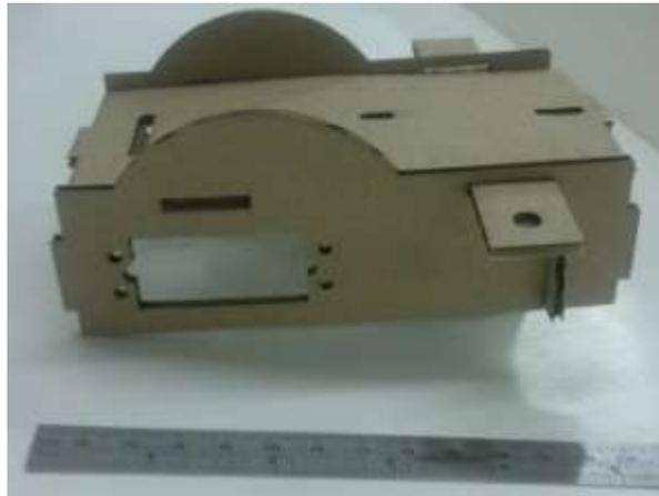
Foto 1. Prueba de concepto de ajuste de piezas.
