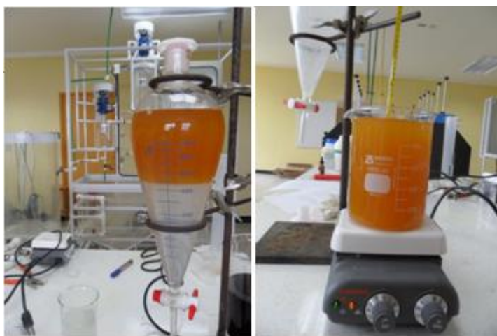
Figura 8. Lavado y secado del biodiesel.
