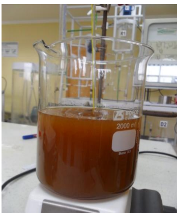
Figura 6. Reacción de transesterificación del aceite de cocina usado en el comedor del ITCR.
