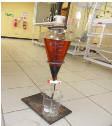
Figura 7. Separación de fases entre el biodiesel crudo y la glicerina cruda.
