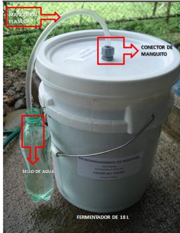
Figura 1. Fermentador de diseño casero con sistema de liberación de gases utilizado en la investigación.
