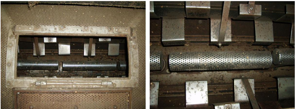
**Figura 1.1** Fotografías del cilindro interno de una guardiola. A la izquierda la vista a través de una de las compuertas de carga y descarga y a la derecha el detalle del cilindro.
