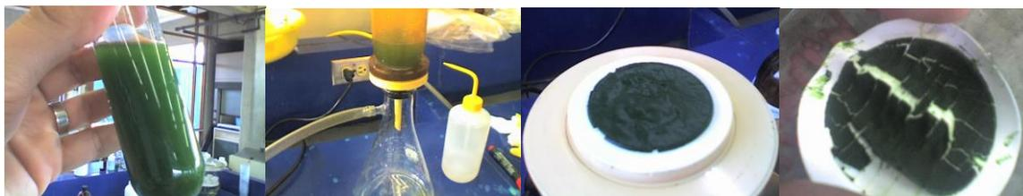
Fig.1: Procedimiento de extracción y secado de biomasa microalgal.
