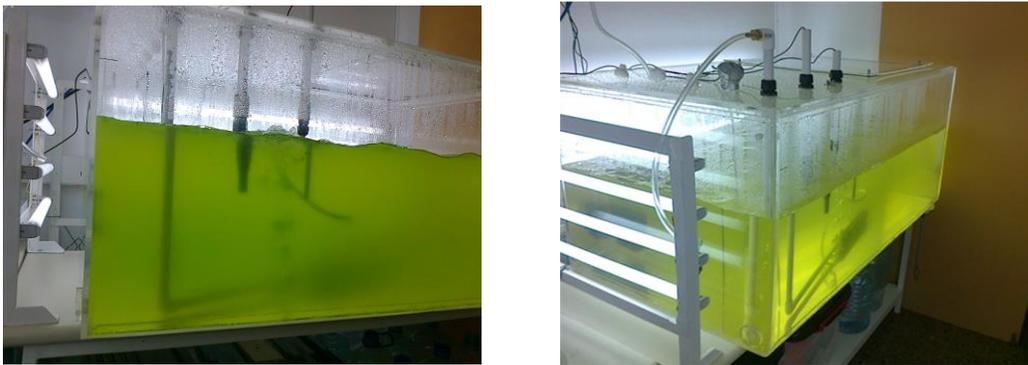
Figura 10. Fotobiorreactor en el laboratorio de microalgas del CIB.
