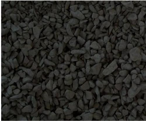
Figura 46. Agregado grueso (piedra cuartilla) usado en la fabricación de las mezclas.
