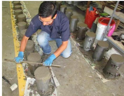
**Figura 35.** Enrasado de 3ra capa de concreto utilizando barra compactadora, técnico de laboratorio.
