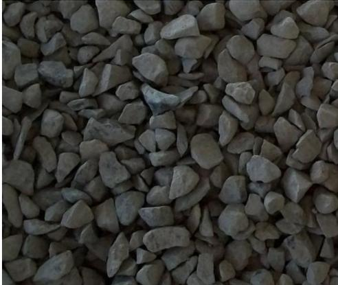
Figura 48. Agregado grueso usado en la fabricación de las mezclas.
