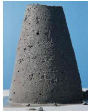
**Figura 2.** Concreto con consistencia rígida (bajo revenimiento) en cono Abrams.<sup>11</sup>
