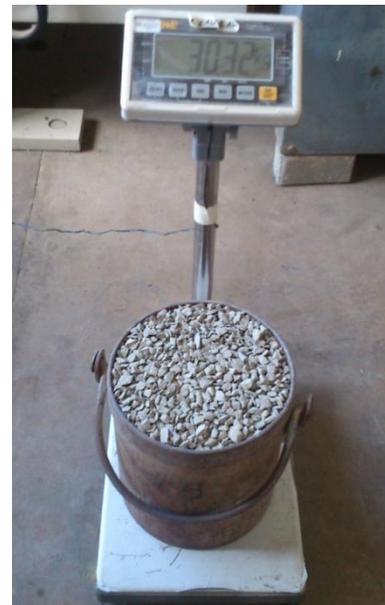
**Figura 25.** Pesado de molde con agregado grueso, ensayo peso unitario compactado.
