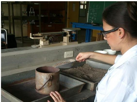
Figura 20. Llenado de recipiente, ensayo peso unitario suelto.
