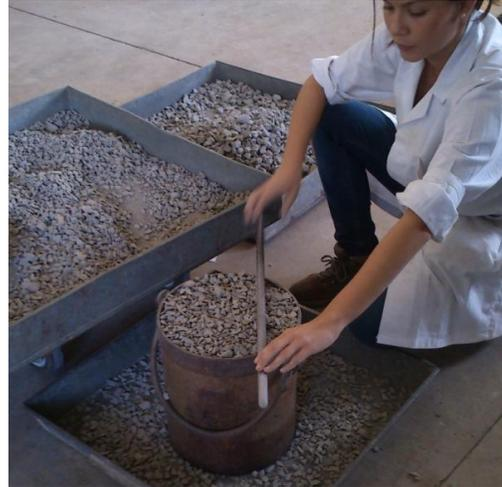
**Figura 24.** Nivelación de superficie con varilla, ensayo peso unitario compactado.
