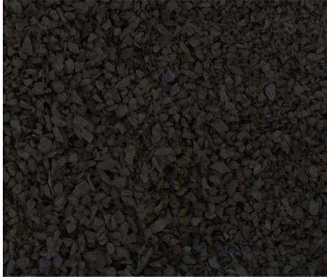
Figura 42. Polvo piedra usado en la fabricación de las mezclas.
