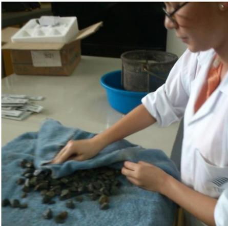
**Figura 29.** Condición saturada superficie seca, ensayo de gravedad específica agregado grueso.
