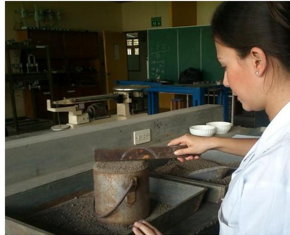
Figura 21. Nivelación de superficie con enrasador, ensayo peso unitario suelto.
