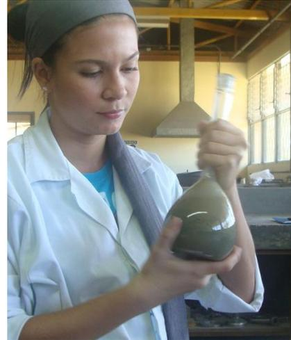
**Figura 32.** Eliminación de burbujas de aire por medio de agitación, ensayo de gravedad específica agregado fino.
