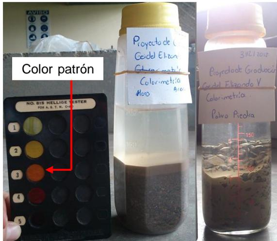
Figura 16. Ensayo de impurezas orgánicas en agregados finos.
