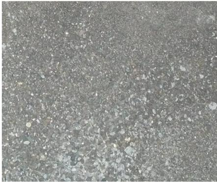
Figura 38. Arena usada en la fabricación de las mezclas.
