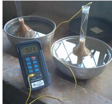
**Figura 33.** Ajuste de temperatura a 23 °C por medio de baño maría, ensayo de gravedad específica agregado fino.
