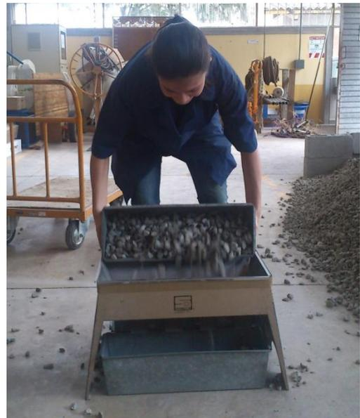
Figura 15. Reducción de muestra por método de divisor mecánico.
