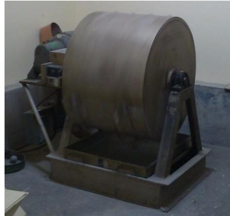
Figura 27. Máquina Los Ángeles, ensayo de abrasión.
