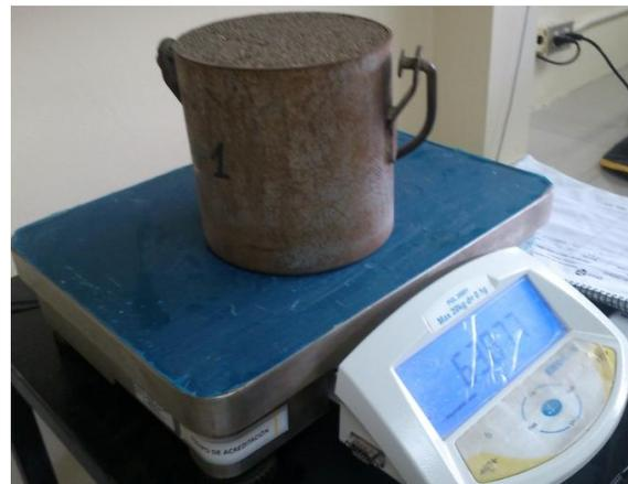
Figura 22. Pesado de molde con agregado fino, ensayo peso unitario suelto.
