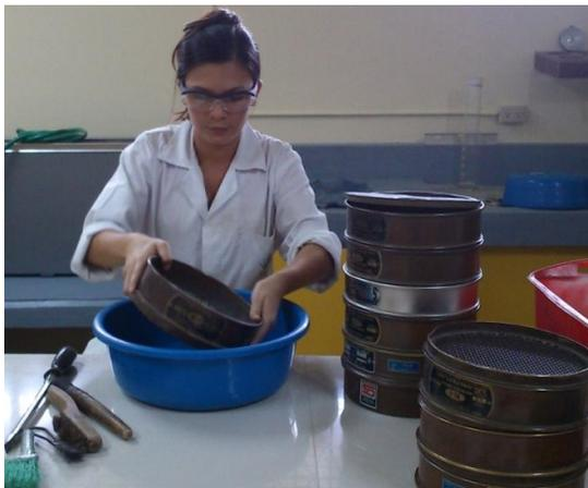
Figura 18. Ensayo de granulometría, agitación de mallas manual.
