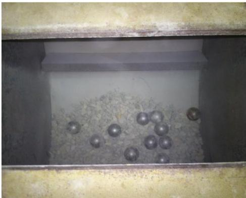
Figura 26. Masa de muestra y carga, ensayo de abrasión.
