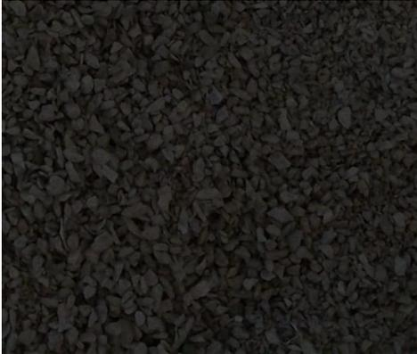
Figura 40. Polvo piedra usado en la fabricación de las mezclas.
