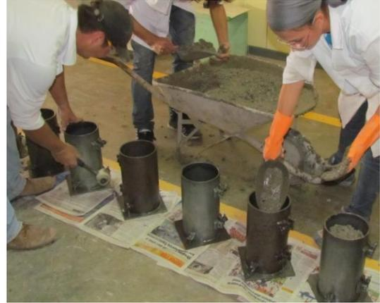
**Figura 34.** Eliminación de burbujas de aire de 1era capa de concreto usando mazo, llenado de 2da capa de concreto.
