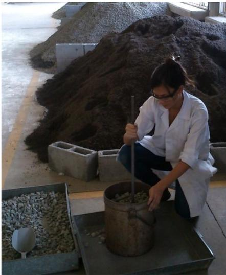
**Figura 23.** Compactación de agregado grueso, ensayo peso unitario compactado.
