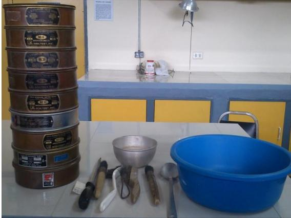
Figura 17. Equipo utilizado en el ensayo de granulometría.
