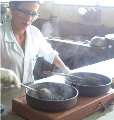
**Figura 31.** Determinación del punto saturado superficie seca, ensayo de gravedad específica agregado fino.
