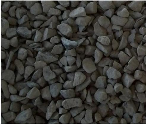
Figura 44. Agregado grueso (piedra cuarta) usado en la fabricación de las mezclas.
