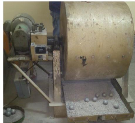
Figura 28. Descarga de material, ensayo de abrasión.
