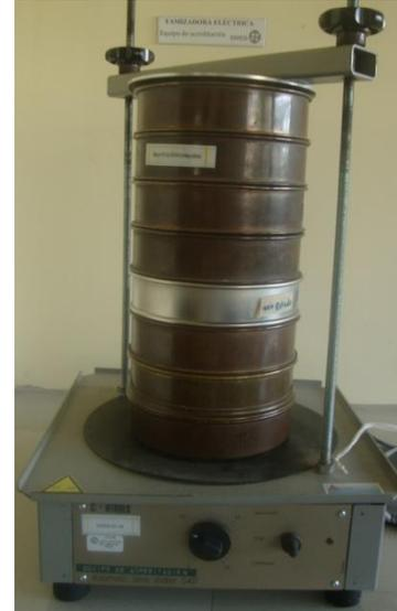
Figura 19. Ensayo de granulometría, agitación de mallas por medio de tamizadora eléctrica.
