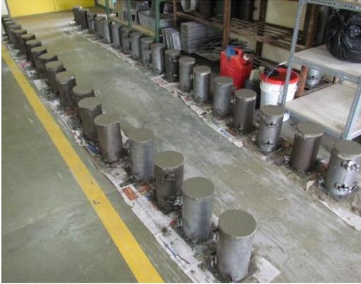
Figura 36. Cilindros de concreto.
