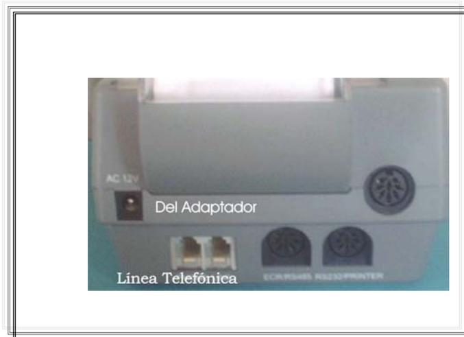
**Figura 3.** Alimentación de corriente y conexión telefónica en la QUISAR 5190
