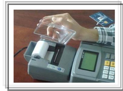
3. Se toma el extremo de papel continuo en la ranura ubicada en la parte inferior de la cinta y se presiona a tecla *LINE FEED* (arrastre de papel) ubicada en el panel de la impresora (Ver Figura 7) hasta que el extremo salga por la parte superior de la cinta. El papel debe salir aproximadamente 1 cm.
