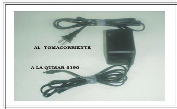
**Figura 4.** Adaptador de corriente para la terminal QUISAR 5190.
