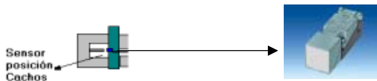
Figura 4.2.6. Sensor de Posición de Cachos .(Detector de Proximidad Inductivo).
