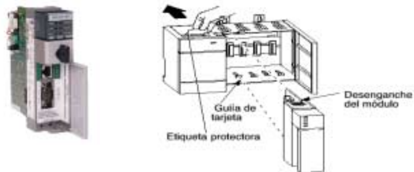
Figura 4.3.9. Módulo Procesador SLC-505 y su respectiva Conexión.
