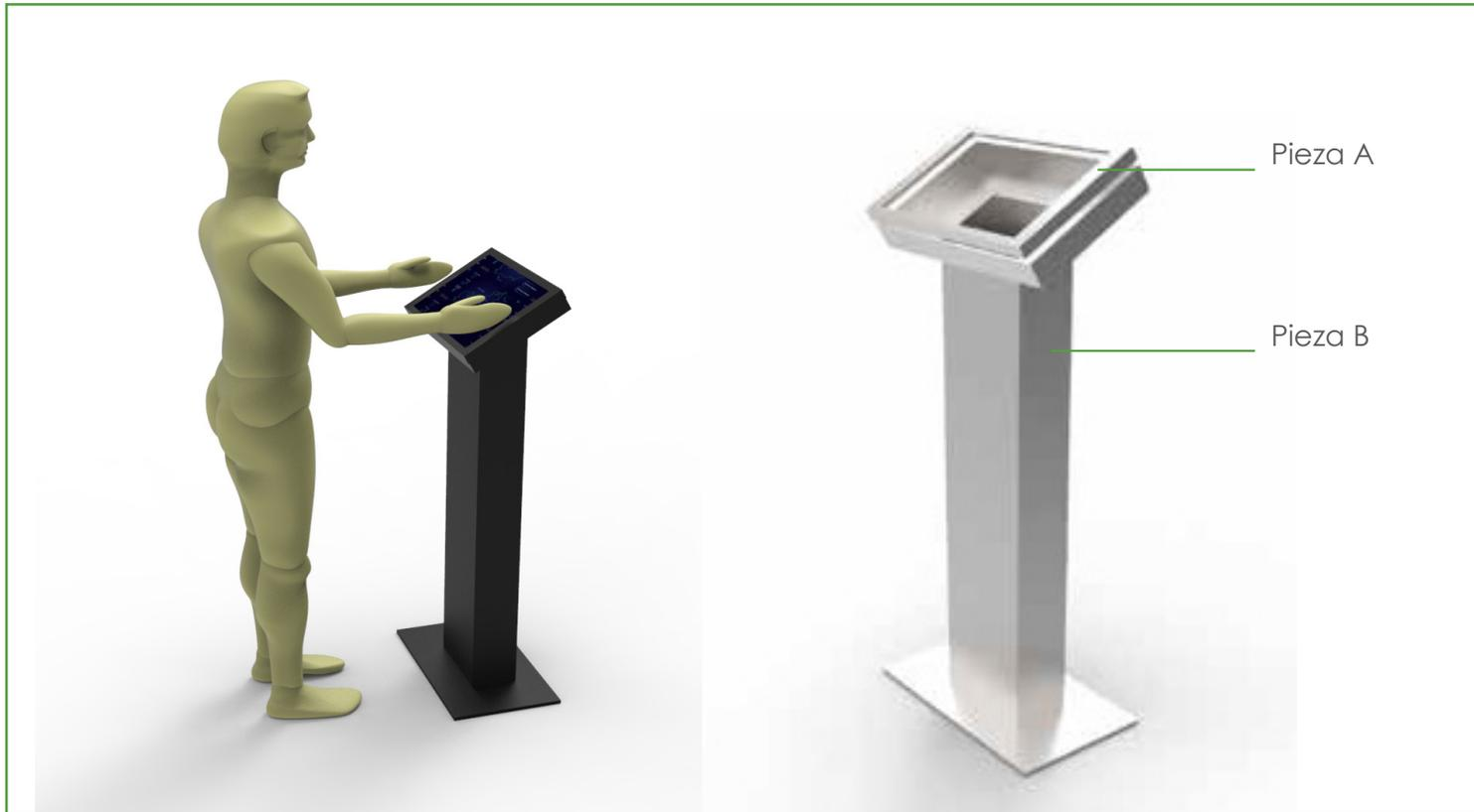
Figura 71. Estructura de la pantalla
