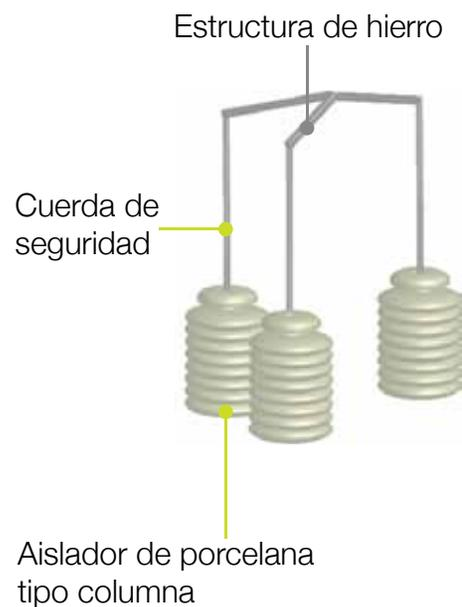
Este supermódulo está formado por tres aisladores de porcelana tipo columna, este aislador tiene un tornillo externo se utilizará para generar una pieza que se adapte al tornillo y se unirá a la cuerda de seguridad, los tres aislantes serán unidos por una estructura de hierro que permite el movimiento giratorio.
